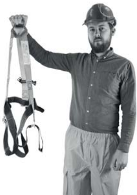
A) Ouvrir les boucles au niveau des jambes et, en tenant les sangles d'épaule, mettre le harnais comme un gilet.
