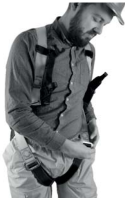
C) Fixer les sangles de jambe. Ajustement et test de suspension : le harnais doit être ajusté pour bien s'adapter afin de réduire le risque de blessure en cas de chute.
